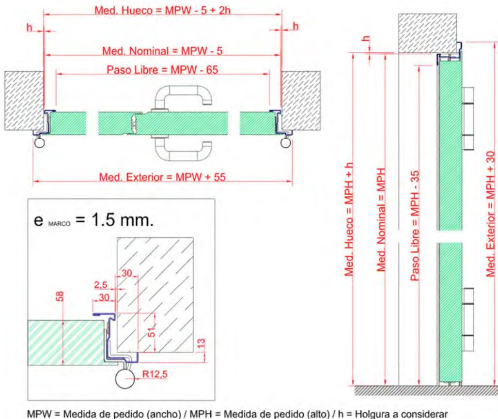
MPW : Largeur Dimension de commande / MPH : Hauteur Dimension de commande / H: Tolérance a considérer
