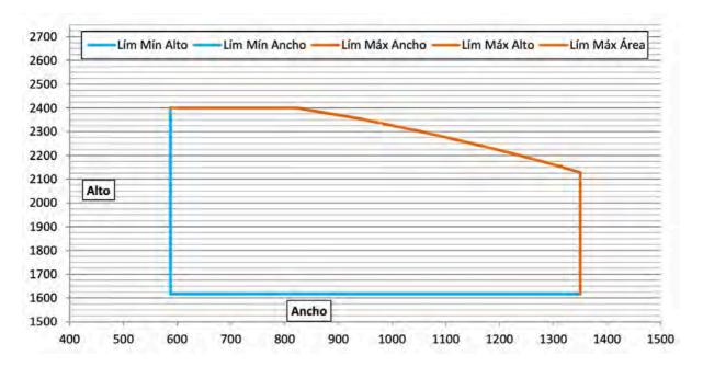
· Domaine dimensionnel pour les installations sur cloisonnement FLEXIBLE (largeur x hauteur) :
